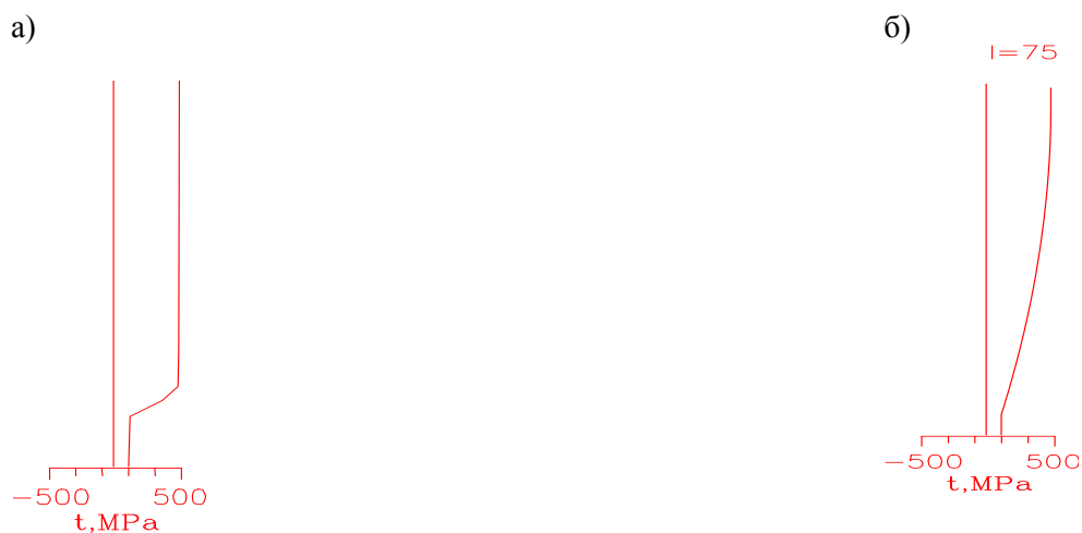
Рис. 1. Эпюры напряжений и перемещений в колонне с прихватом длиной 75м: по высоте всей колонны(а), на прихваченном участке (б)
