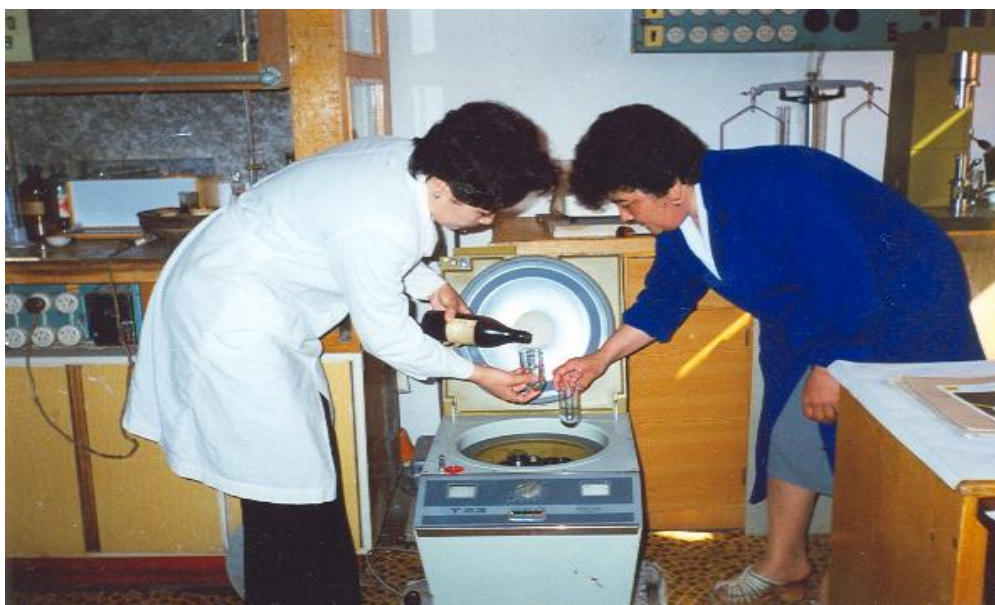
1-сурет. Жоғарыда аталған приборлар көмегімен мұнайдың физика-химиялық қасиеттерін зерттеу үшін Т-23 (Германия) центрифугасында шикі мұнайды бір мезгілде эмульсиялық судан және механикалық қоспалардан айыру.
