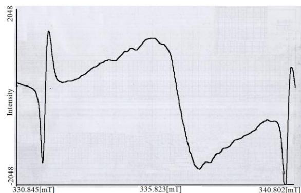
Рисунок 4 – Спектр ЭПР углеродных пленок, полученных в магнетронном разряде с нафталином на подложке из стекла.
