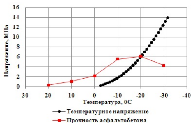
Рисунок 20. К определению момента времени растрескивания асфальтобетонного покрытия
