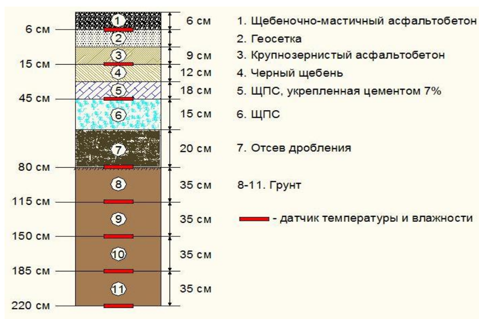
Рисунок 11. Схема расположения датчиков в дорожной конструкции
