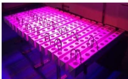
Рисунок 13 – гидропонный рассадный стенд с применением светодиодного освещения с биологическим спектром.
