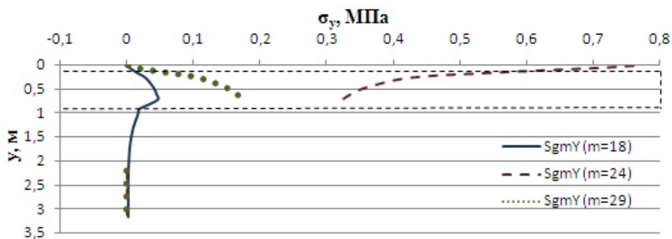
Рисунок 15 – Графики изменения нормальных напряжений \sigma_y в конструкции с коллектором в вертикальных сечениях IV-IV, V-V и VI-VI
